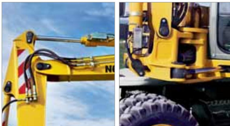
**T**ubazioni per l'azionamento e la rotazione della benna mordente montate di serie. Distributore con predisposizione per martello idraulico e pinza.
