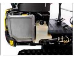
Indicatori di livello visibili dall'esterno, per un facile controllo dei livelli olio idraulico e carburante.
