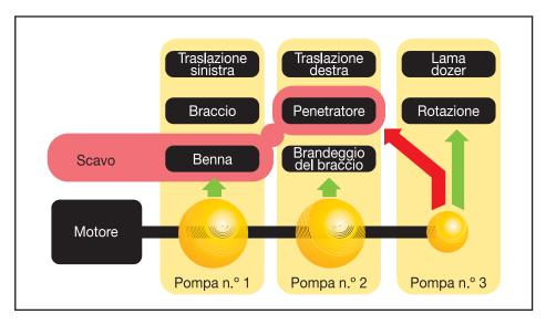
Nel momento stesso in cui la macchina inizia le operazioni di scavo, la terza pompa (che alimenta i circuiti della rotazione e della lama) eroga una potenza idraulica supplementare al circuito del penetratore, assicurandone un funzionamento rapido e regolare anche con carichi pesanti.
