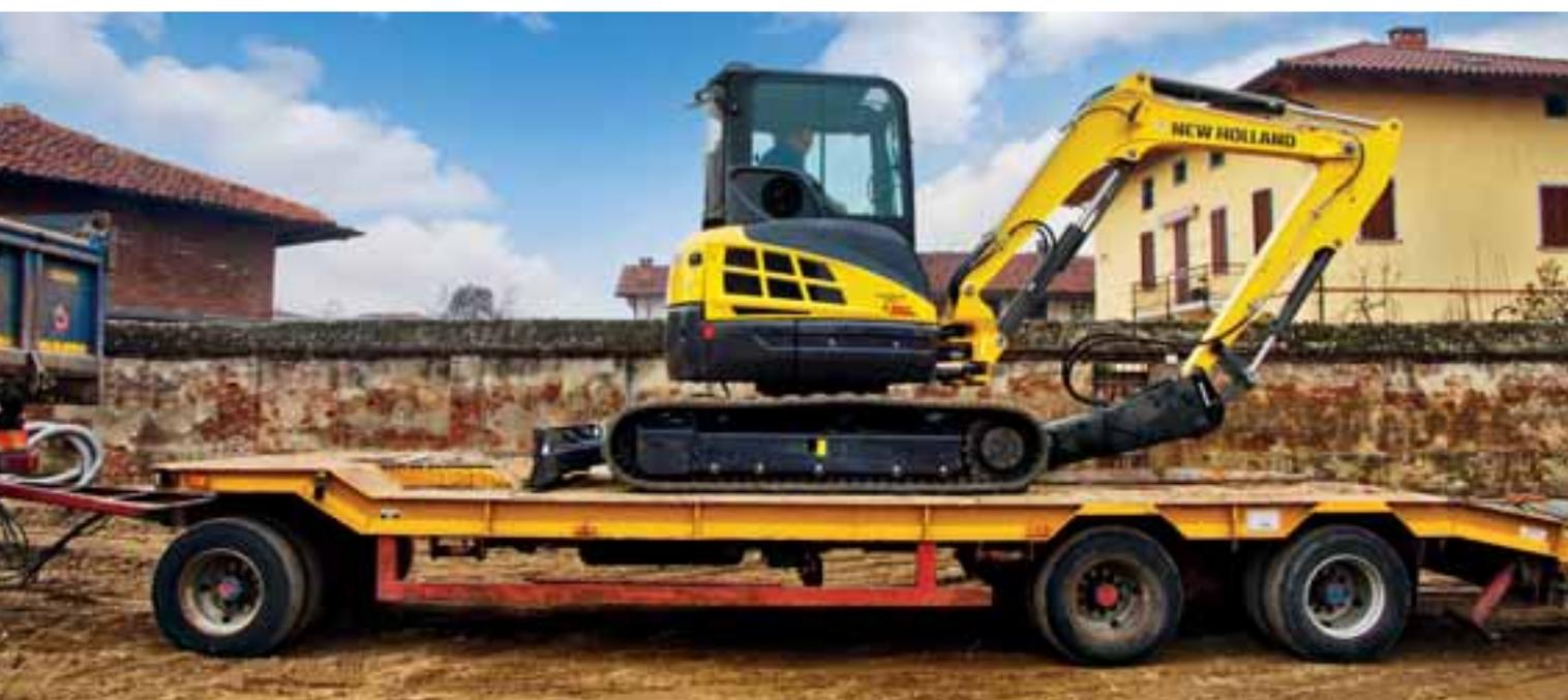
I mini Escavatori New Holland Construction di gamma media e alta sono facilmente trasportabili su autocarri di medie dimensioni e anche su carrelloni di maggiori dimensioni. Le ridotte dimensioni in larghezza consentono di affiancare ai mini altre attrezzature e macchine (rulli, ecc.) di un'impresa edile, massimizzando lo spazio a disposizione.
