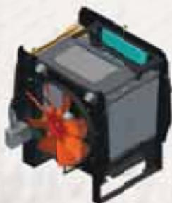
La maggior parte delle pale gommate utilizza radiatori sovrapposti. Noi di New Holland li abbiamo riuniti in un unico modulo, il "cooling box", che consente di ottenere un migliore raffreddamento, capace di prolungare la durata dell'olio di 500 ore. Inoltre la pulizia dei singoli radiatori è molto semplice.
