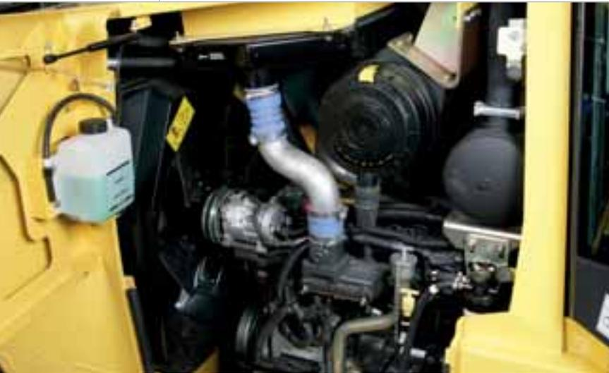
Il nuovo motore CNH Common Rail è un gioiello della tecnologia, progettato per sviluppare una potenza e una coppia elevate e ridurre il consumo di carburante e le emissioni inquinanti. Rispetto al modello precedente, a parità di regime (2.200 giri/min) il nuovo motore sviluppa un 12% in più di potenza massima e la coppia passa da 650 a 690 Nm.
