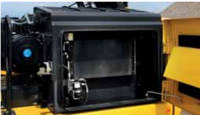
I componenti del sistema di raffreddamento (radiatore, radiatore dell'olio idraulico e intercooler) sono montati in parallelo per migliorare l'efficienza e l'affidabilità e offrire al contempo una maggiore facilità di controllo e pulizia
