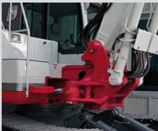
Unica macchina di categoria dotata di brandeggio
