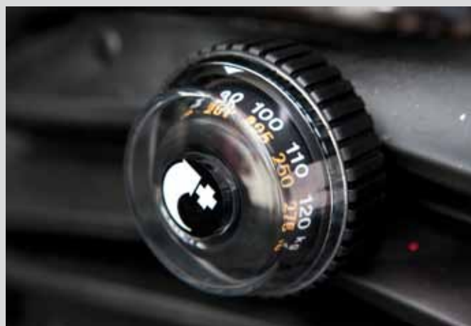
Sedile ammortizzato regolabile, secondo il peso dell'operatore
