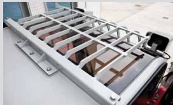
Griglia protezione vetro superiore cabina
