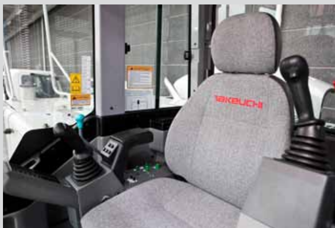
Sedile ammortizzato regolabile, secondo il peso dell'operatore
