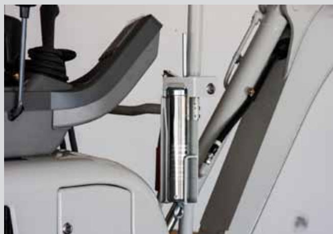
Pompa grasso con specifico alloggiamento
