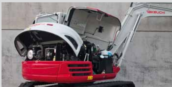
Pratico accesso alle parti meccaniche ed idrauliche
