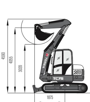
Fig. 2: Braccio ad orbita circolare - altezza di carico
