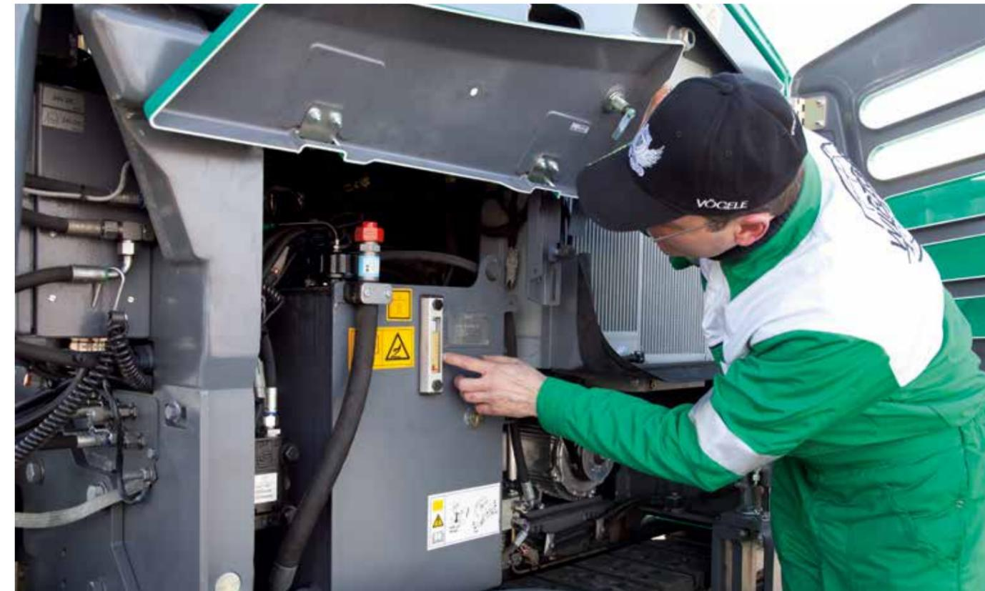
Le procedure manutentive unificate per tutte le finitrici "tratto 3" agevolano e velocizzano la manutenzione. Tutti i punti di manutenzione della macchina sono facilmente accessibili grazie ad ampi portelloni.
