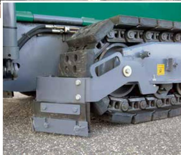
» **Potenti motori idraulici** indipendenti integrati direttamente nelle ruote motrici dei cingoli permettono la massima conversione della potenza motrice in velocità di stesa.
