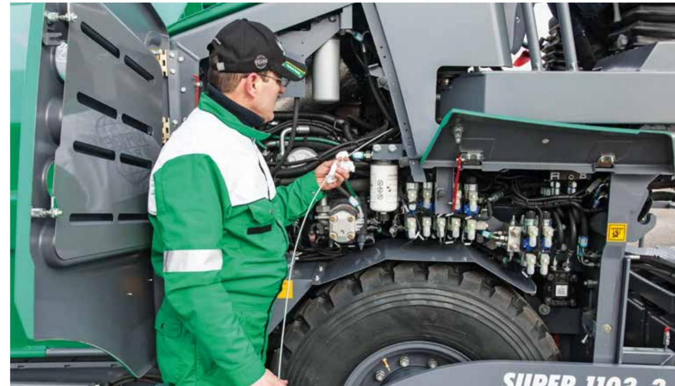
Le procedure manutentive unificate per tutte le finitrici "tratto 3" agevolano e velocizzano la manutenzione. Tutti i punti di manutenzione della macchina sono facilmente accessibili grazie ad ampi portelloni.
