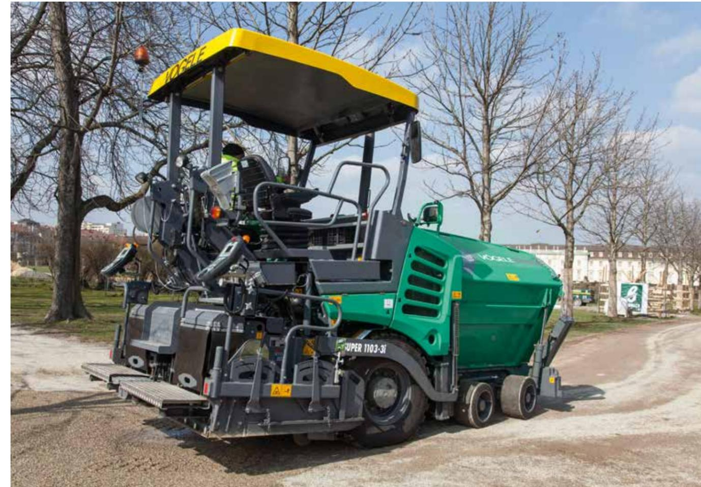
Nelle finitrici gommata della generazione "tratto 3" il freno sterzante "Pivot Steer" riduce la coppia della ruota posteriore interna alla curva. Essendo ora le macchine "tratto 3" quasi in grado di compiere piroette sul posto, il raggio di sterzata esterno si riduce a soli 3,8 m.
