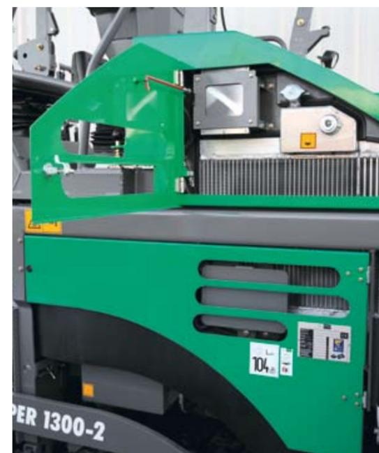
Le procedure manutentive unificate per tutte le finitrici "tratto 2" agevolano e velocizzano la manutenzione. Tutti i punti di manutenzione della macchina sono facilmente accessibili grazie ad ampi portelloni.
