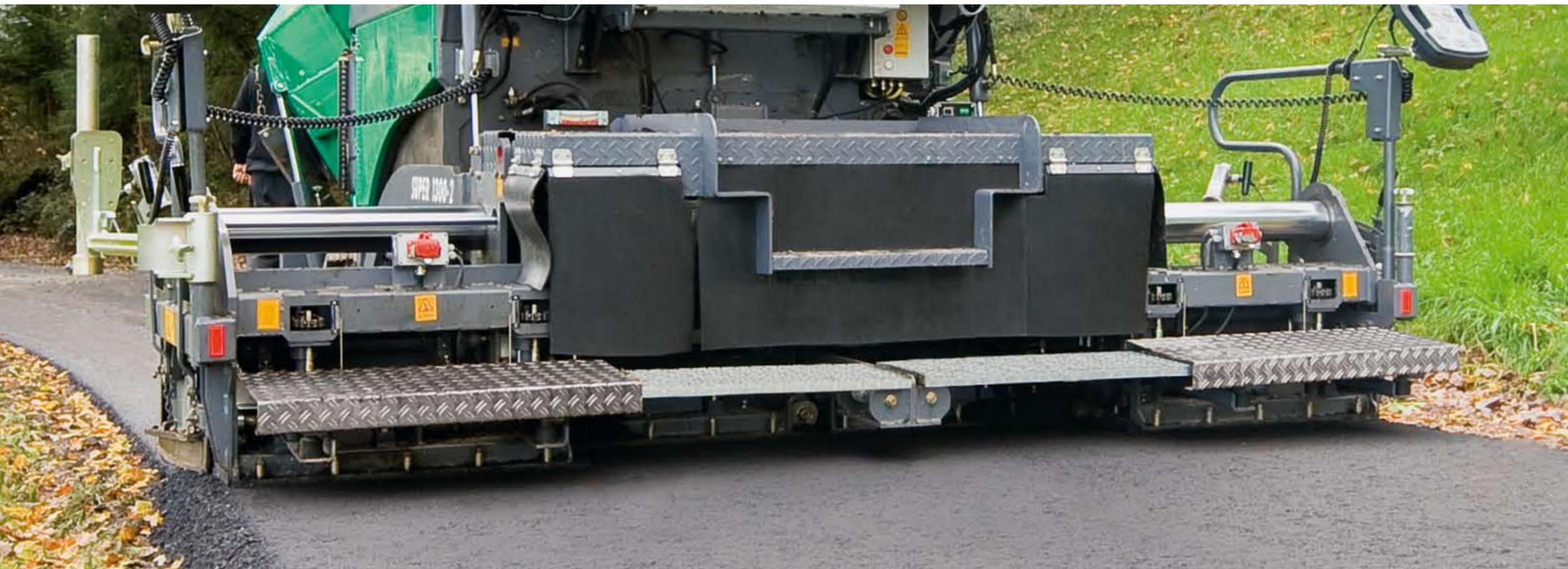
Il banco di stesa AB 340 TV è il rasatore perfetto per la SUPER 1300-2. Ha una larghezza base di 1,8 m, estensibile idraulicamente fino a 3,4 m.
