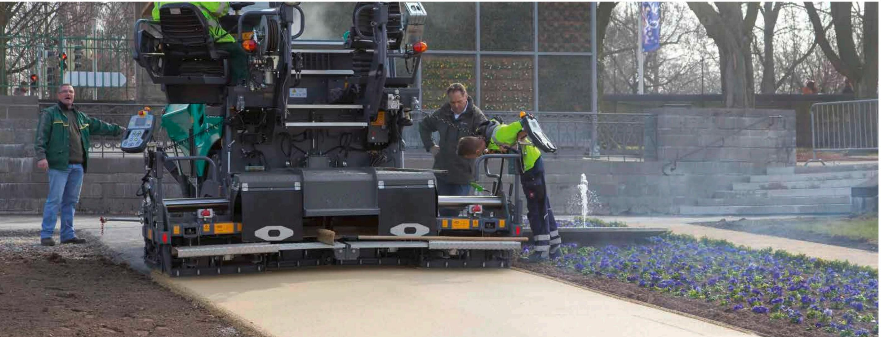
Il banco di stesa AB 340 TV è il rasatore perfetto per la SUPER 1303-3i. Ha una larghezza base di 1,8 m, estensibile idraulicamente fino a 3,4 m. Con elementi di allargamento rigidi la larghezza di stesa può essere ampliata fino a 4,5 m.
