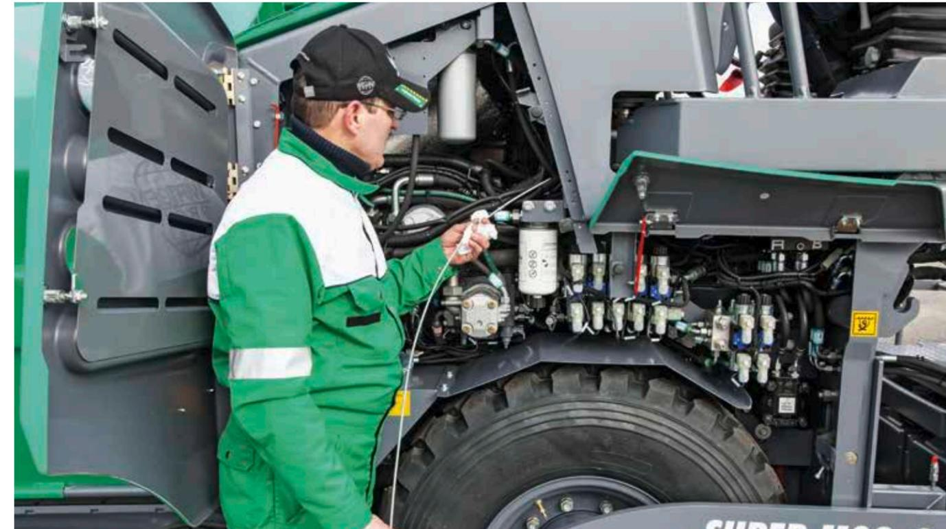
Le procedure manutentive unificate per tutte le finitrici "tratto 3" agevolano e velocizzano la manutenzione. Tutti i punti di manutenzione della macchina sono facilmente accessibili grazie ad ampi portelloni.
