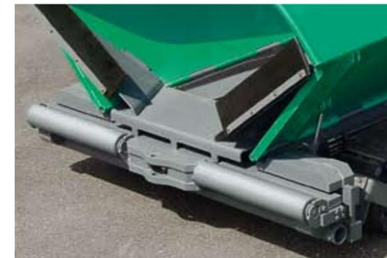
Rulli respingenti particolarmente larghi montati su una traversa oscillante permettono agli autocarri approvvigionatori di accostarsi alla finitrice agevolmente e senza trasmetterle scossoni anche nelle curve.
