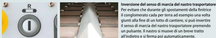
**Inversione del senso di marcia del nastro trasportatore**
