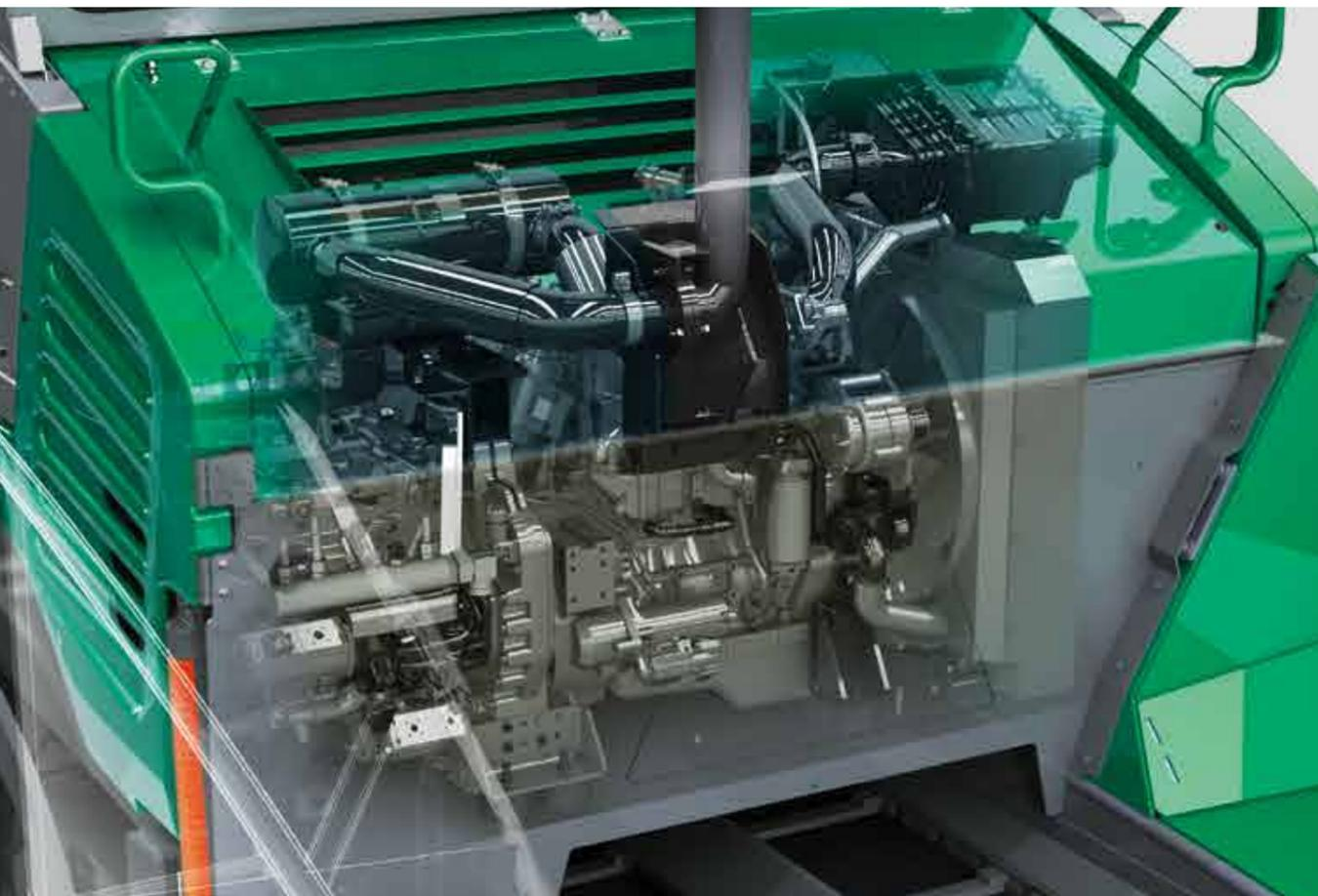
Un moderno motore Cummins raffreddato ad acqua da 116 kW spinge la SUPER 1600-3i. Il suffisso "i" sta per "intelligent emission control" e indica tutte le macchine del WIRTGEN GROUP che sono dotate delle soluzioni motoristiche più avanzate.
