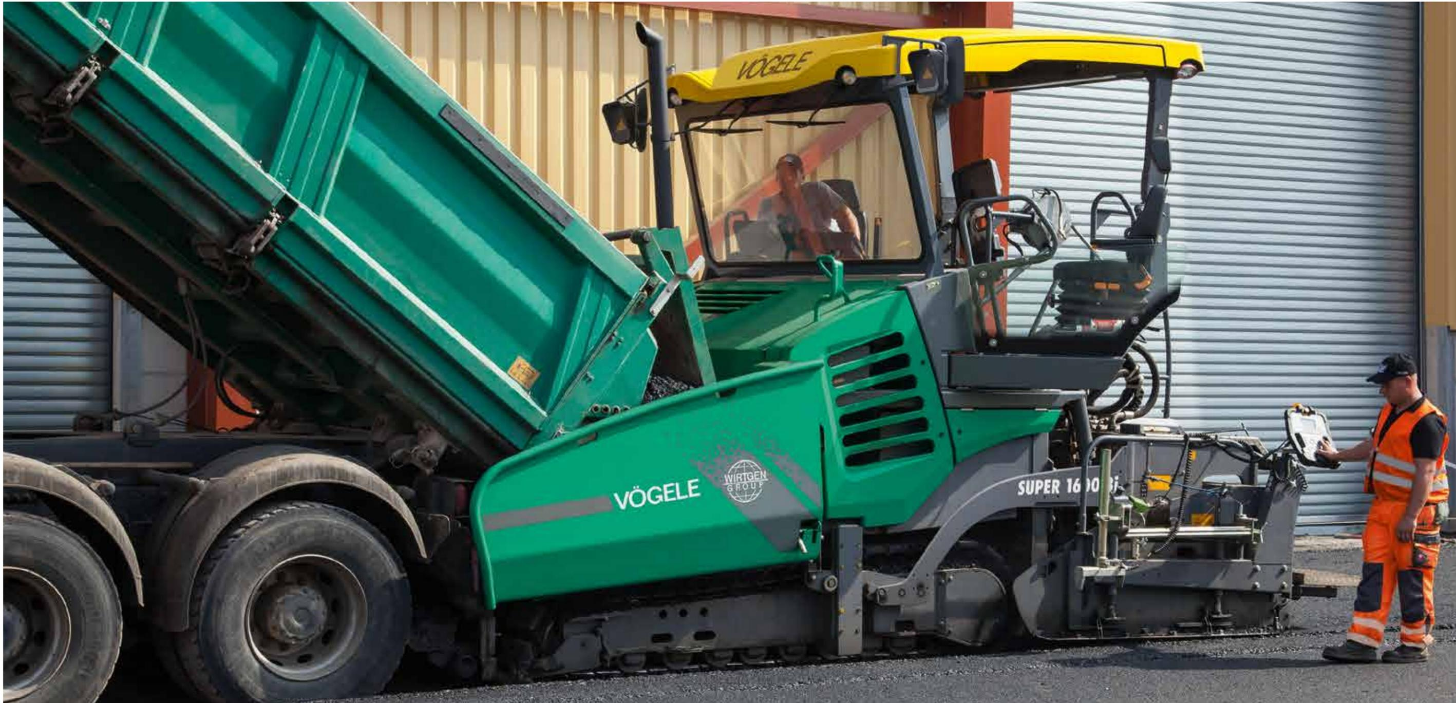
Il presupposto di base per una pavimentazione di alta qualità e planarità è un'alimentazione costante del materiale alla finitrice. "PaveDock", il rullo respingente su molle, impedisce in modo efficiente la trasmissione di scossoni dai camion approvvigionatori alla finitrice durante le manovre di accostamento.
