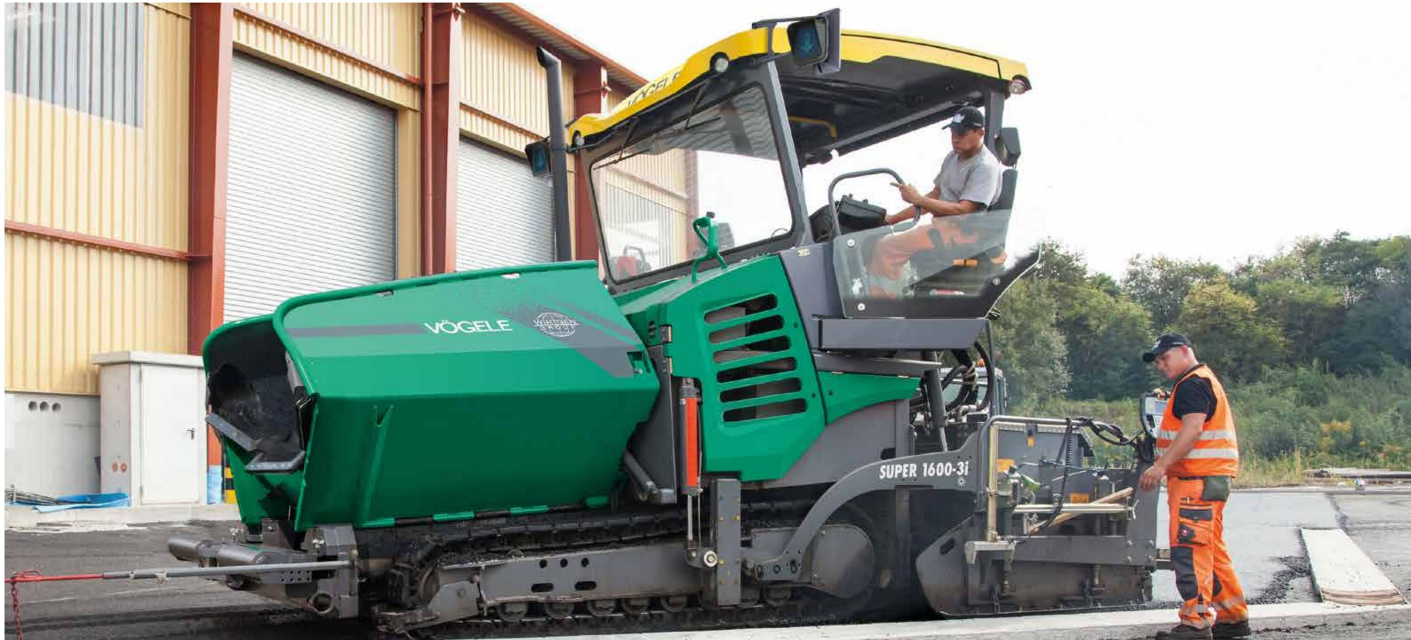
Una finitrice compatta, potente, maneggevole e ancora più versatile del modello precedente: la nuova SUPER 1600-3i è davvero imbattibile. Questa tipica rappresentante della Universal Class è in grado di operare senza problemi con larghezze di stesa fino a 6,5 m. I suoi componenti di propulsione e trazione di alta qualità garantiscono insieme
