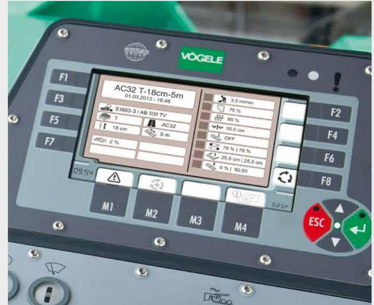
La funzione automatica relativa ai programmi di stesa consente al personale operatore di creare determinati programmi di stesa. È possibile salvare tutti i principali parametri per la stesa di un determinato strato, ad es. uno strato di base in conglomerato bituminoso dello spessore di 18 cm.
