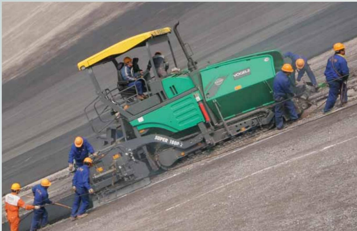
La SUPER 1800-2 trasformata in una finitrice per scarpate si presta in maniera eccellente alla posa in opera di conglomerati su pendii ripidi fino a 32°, ad esempio nella costruzione di discariche, canalizzazioni o invasi. Per tali condizioni estreme si sono apportate numerose modifiche alla SUPER 1800-2 sia per assicurare l'affidabilità in esercizio della macchina che per garantire la sicurezza operativa della squadra di stesa.
