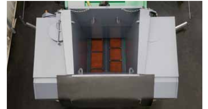
Quando si usa la cisterna aggiuntiva, l'approvvigionamento del conglomerato è affidato a un alimentatore.
