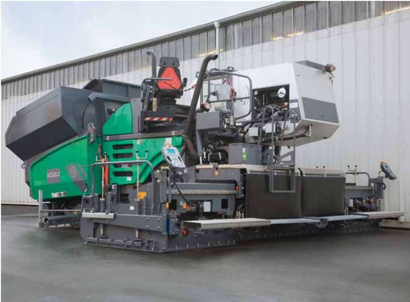
Il banco AB 600-2 ha una larghezza base di 3 m ed è estensibile idraulicamente fino alla larghezza massima di spruzzatura di 6 m.
