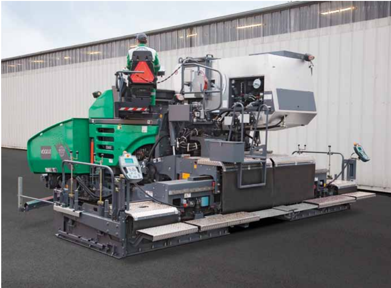
Il banco AB 500-2 può essere allargato idraulicamente da 2,55 a 5 m. Per gli interventi con larghezza operativa di 6 m il banco può essere attrezzato con elementi allargatori da 75 cm. La larghezza massima del banco è limitata elettronicamente a 6 m.
