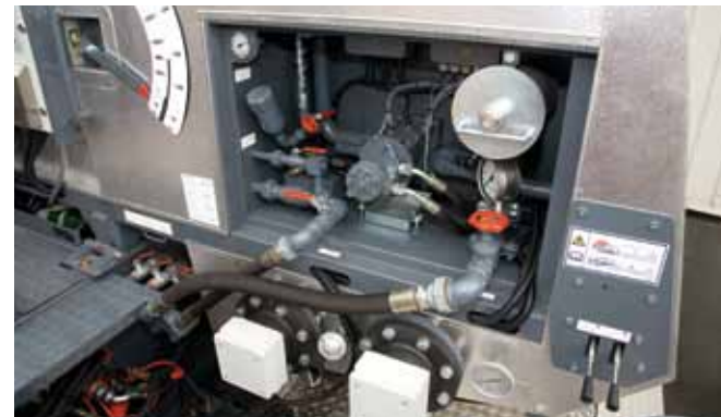
Una pompa riscaldata mantiene in circolazione l'emulsione garantendone uno stato sempre omogeneo.
