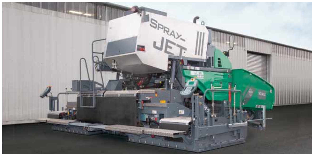
Una pompa riscaldata mantiene in circolazione l'emulsione garantendone uno stato sempre omogeneo.
