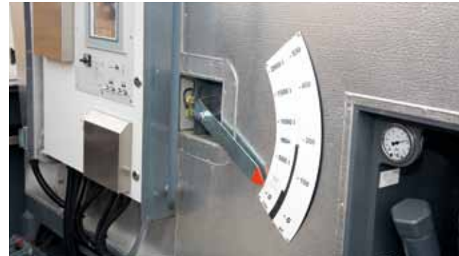
Un indicatore di livello ben visibile informa la squadra di stesa sulla quantità di emulsione contenuta nella cisterna.
