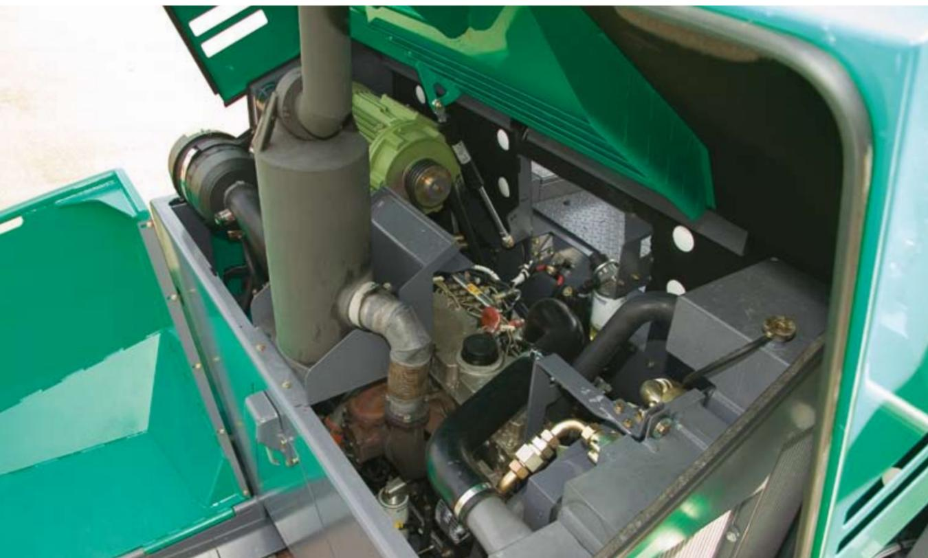
Un moderno motore Perkins raffreddato ad acqua da 129,6 kW spinge la SUPER 1800-2. I regimi di giri MIN, ECO e MAX consentono di modulare finemente la potenza erogata dal motore. Per il 70 – 80% di tutti gli interventi è sufficiente la modalità ECO, che permette di ridurre il consumo di gasolio, l'usura e le emissioni sonore.
