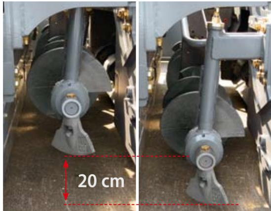
Le coclee distributrici della SUPER 1800-2 offrono tutte le possibilità per ottenere, in ogni situazione di stesa, una distribuzione ottimale del materiale davanti al banco. Con i loro singoli azionamenti idraulici molto potenti, il nastro convogliatore e la coclea distributtrice assicurano prestazioni di stesa fino a 700 t/h.
