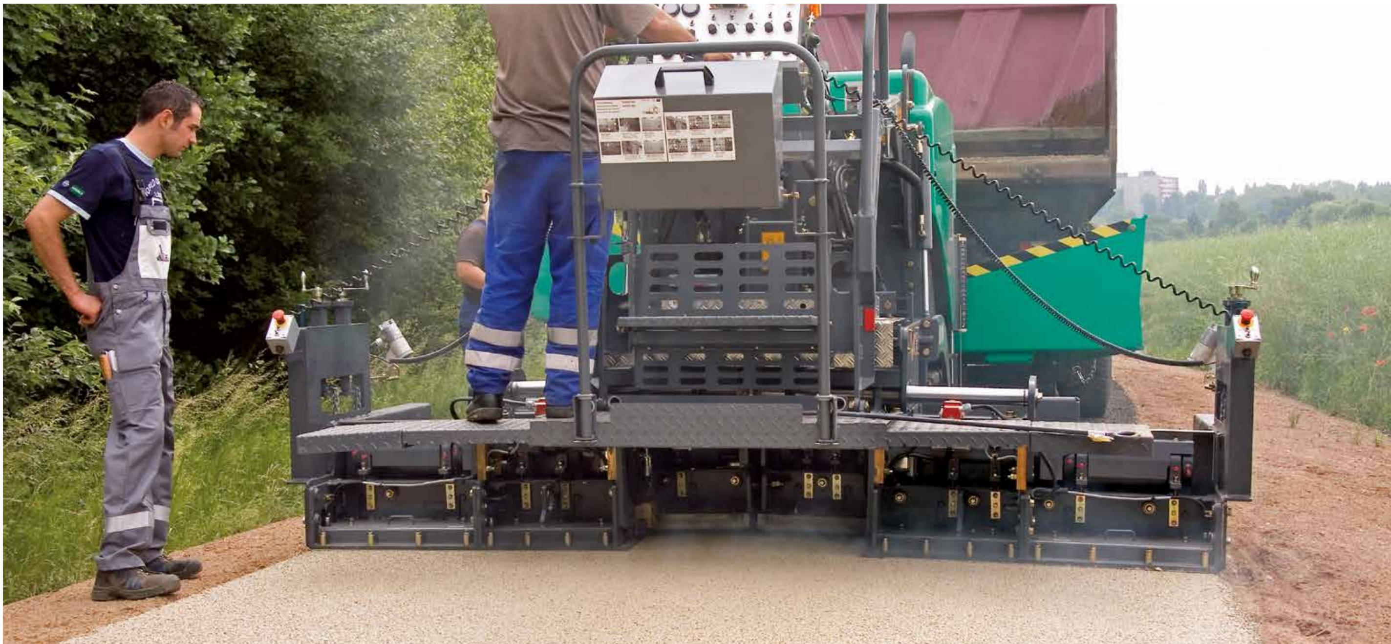
Il banco di stesa AB 200 TV è concepito appositamente per l'uso con la SUPER 800. Il banco di stesa ha una larghezza base di 1,1 m. E' estensibile idraulicamente ad una larghezza di 2 m. Con l'aiuto di elementi di allargamento rigidi, l'AB 200 TV può essere portato ad una larghezza massima di 3,2 m. Il ventaglio d'impiego della SUPER 800 con AB 200 TV spazia quindi
