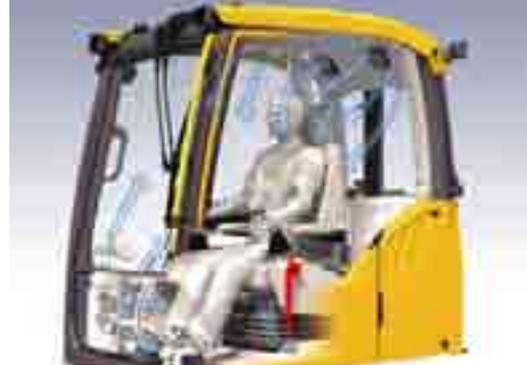
• La migliore capacità di riscaldamento/raffreddamento del settore con 14 bocchette di ventilazione.
