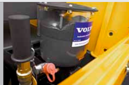
Impianto di autolubrificazione
