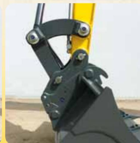
L'innovativo sistema idraulico a cambio rapido è predisposto perfettamente per il cinemismo degli escavatori compatti Wacker Neuson perché ottimizza i processi di lavorazione: accosta, ammucchia e chiude automaticamente. Per la scarsa altezza della costruzione l'angolo di apertura e chiusura della pala restano invariati: contributo essenziale per un migliore flusso di lavoro.
