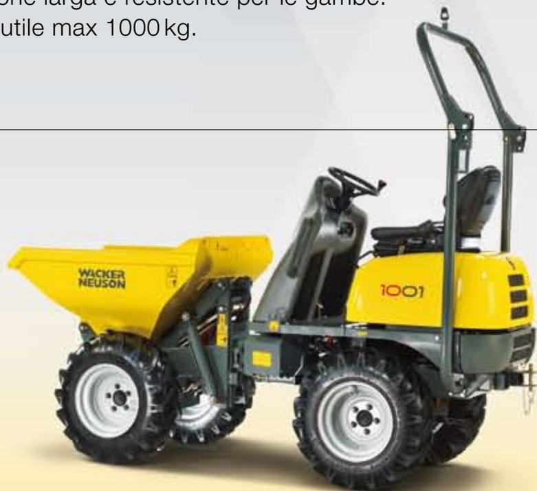
1 L'archetto di sicurezza ribaltabile (ROPS) aumenta la sicurezza di esercizio. Per il passaggio sotto altezze ridotte può essere ribaltato.
