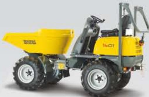
L'archetto di sicurezza ribaltabile (ROPS) aumenta la sicurezza di esercizio. Può essere ribaltato per il passaggio sotto altezze ridotte e per il trasporto del dumper.
