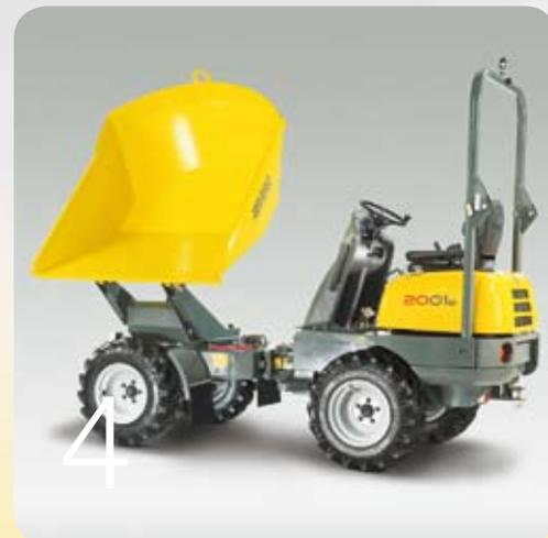
**Cassone ribaltabile ruotante di serie. Dispositivo di autocaricamento come opzione. E molto altro.**
