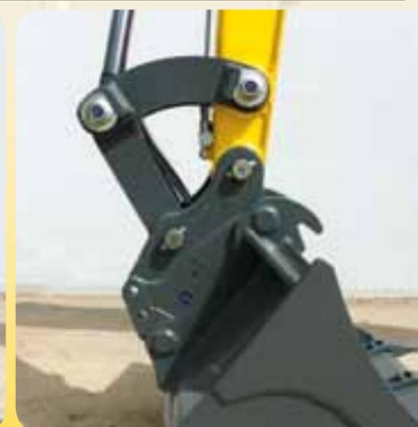
L'innovativo sistema idraulico a cambio rapido è predisposto perfettamente per il cinematismo degli escavatori compatti Wacker Neuson perché ottimizza i processi di lavorazione: accosta, ammucchia e chiude automaticamente. Per la scarsa altezza della costruzione l'angolo di apertura e chiusura della pala restano invariati: contributo essenziale per un migliore flusso di lavoro.
