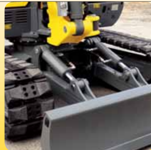
Cingolato ibrido di lunga durata per asfalto e superfici angolari con elementi singoli sostituibili.
