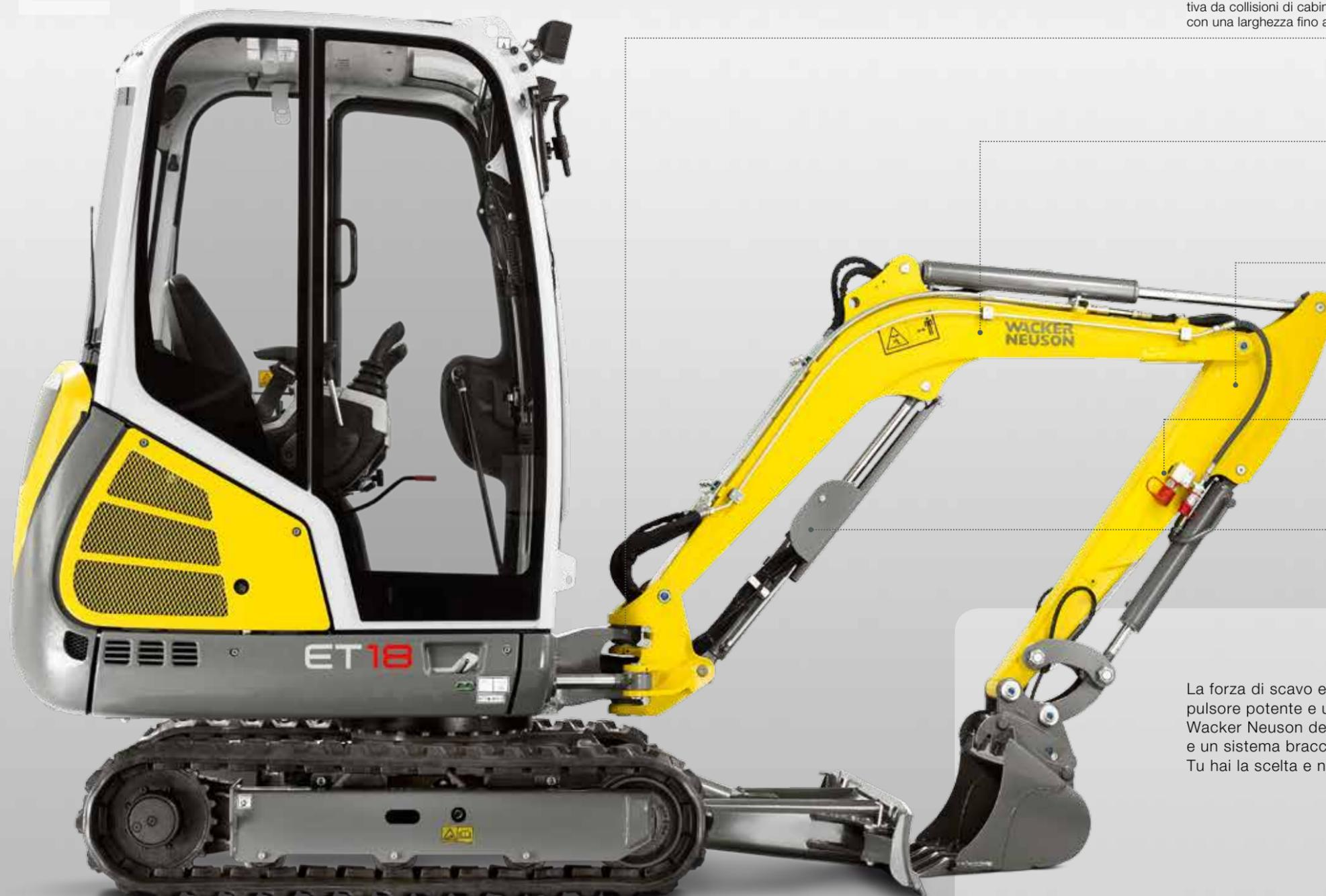
**Piena visibilità e migliore protezione.** Il percorso della tubazione dalla cilindrata al telaio passa attraverso la console di rotazione divisa in due. Si garantisce la piena protezione e una perfetta visibilità durante l'esercizio.
