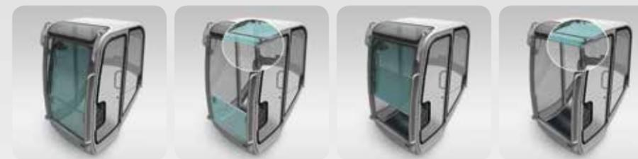
**Apertura innovativa per il lavoro quotidiano.** Il sistema innovativo di apertura per il parabrezza facilita la ventilazione della cabina e la comunicazione con l'operatore. Togliere il parabrezza e immagazzinarlo separatamente appartiene quindi al passato.
