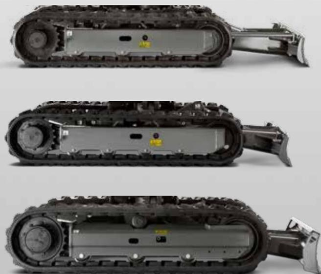
**I meccanismi di traslazione (ET18, ET20) sono dotati di 2 varianti di lama.** E questo convince. Per tutti i meccanismi ottimizzati per ogni modello della Serie ET sono disponibili rispettivamente due lunghezze di lama (ET18, ET20). Ciò consente un adeguamento ottimale alle attrezzature. E il non plus ultra è che il VDS (Vertical Digging System) è disponibile per tutti i modelli di questa classe come optional.
