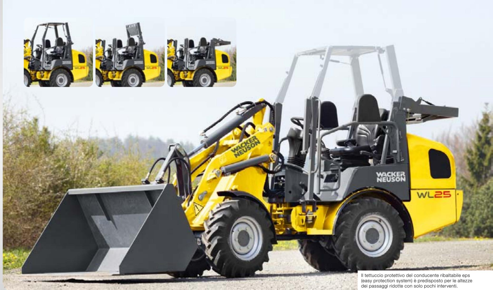
Il tettuccio protettivo del conducente ribaltabile eps (easy protection system) è predisposto per le altezze dei passaggi ridotte con solo pochi interventi.
