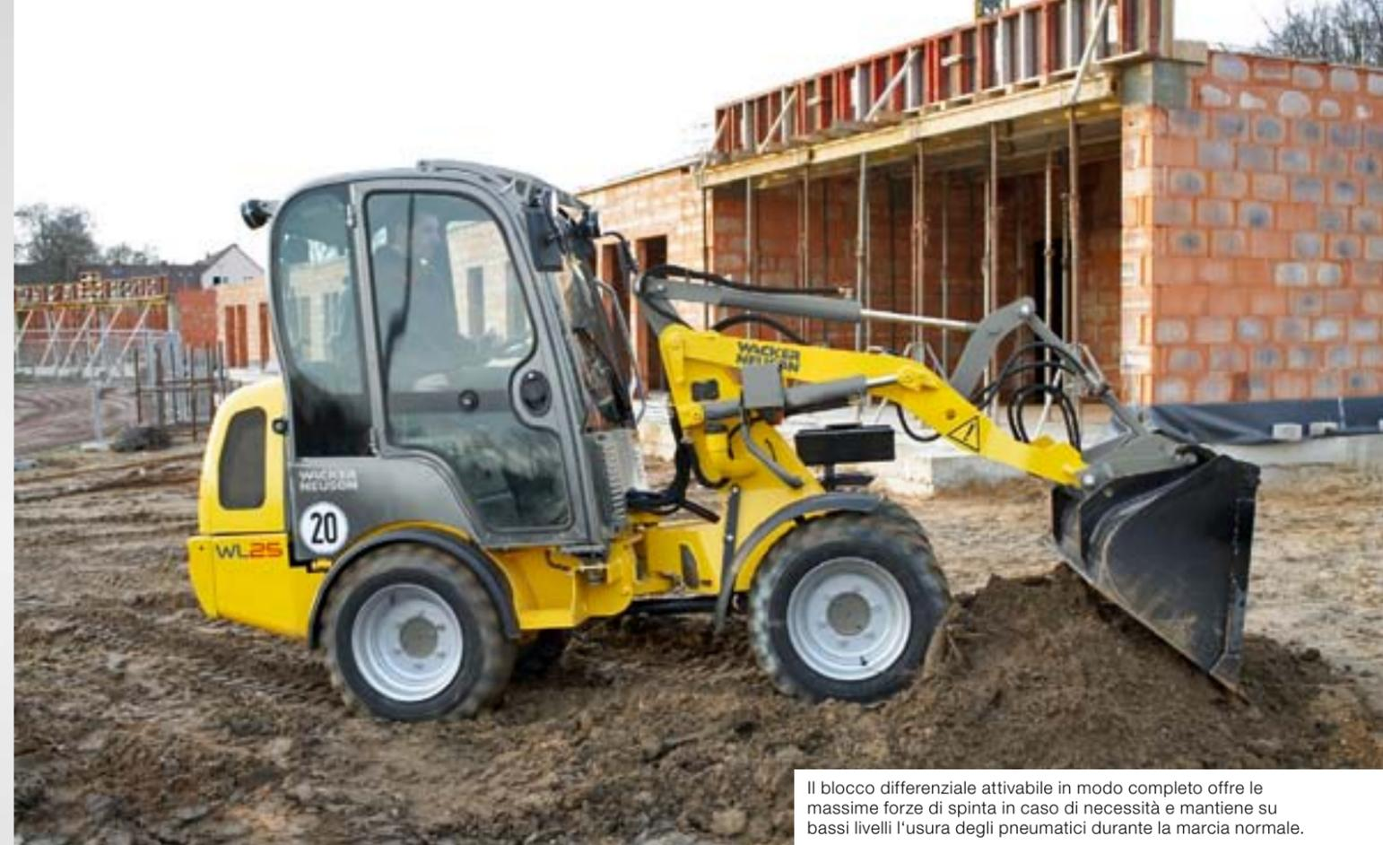
Il blocco differenziale attivabile in modo completo offre le massime forze di spinta in caso di necessità e mantiene su bassi livelli l'usura degli pneumatici durante la marcia normale.
