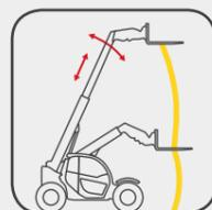
**Lavorare in modo più sicuro che mai.** L'innovativo sistema di assistenza al conducente VLS (Vertical Lift System) si avvia per esempio in modo semiautomatico e intelligente in presenza di pericolo di sovraccarico, abbassando o ritraendo il braccio telescopico senza interrompere il lavoro. Ciò garantisce sicurezza, comfort ed efficienza nello stesso tempo.
