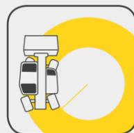
**Piccolo raggio di sterzata, grande potenza.** Tutti i sollevatori telescopici di Wacker Neuson offrono un raggio interno particolarmente ridotto di 595 mm: l'ideale per utilizzarli in vari modi e quasi ovunque.
