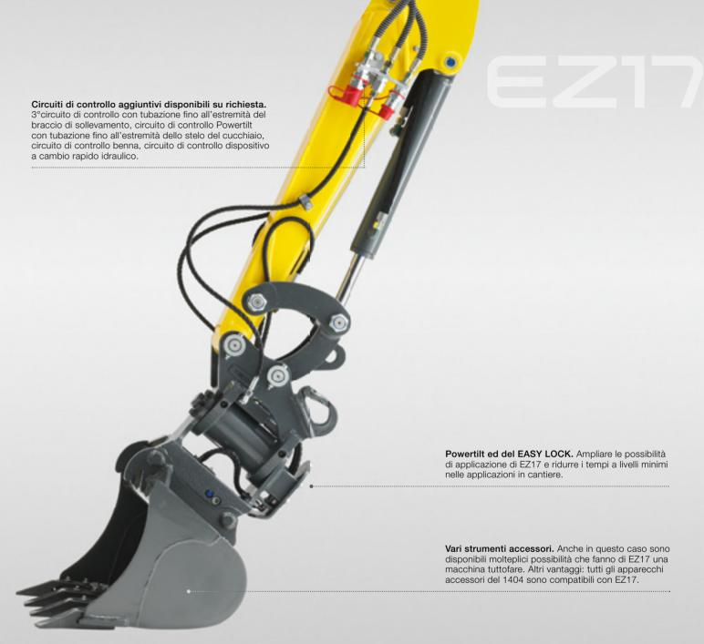
Adattamento alla velocità del lavoro grazie ad un espediente. Il sistema di bracci e il sistema di controllo proporzionale del EZ17.
