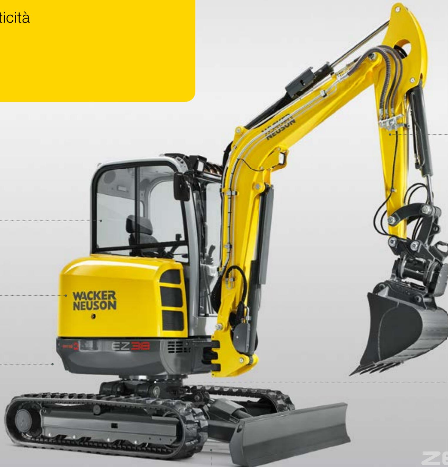
**La dotazione giusta per qualsiasi sfida del futuro.** Per quanto riguarda l'impianto idraulico modificato, risulta installata di serie una sezione aggiuntiva per il circuito di controllo II/III. Questa soluzione consente un facile aggiornamento di circuiti di controllo aggiuntivi rendendo la macchina ancor più flessibile.
