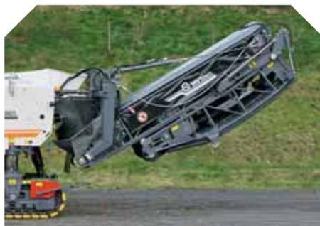
... e di 45 gradi su quello sinistro per garantire la massima flessibilità nel caricamento del fresato ▲
