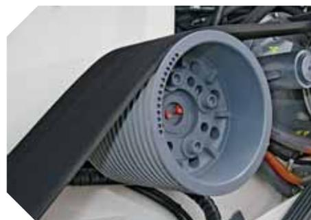
Un cilindro idraulico mantiene automaticamente costante la tensione delle cinghie di trasmissione ▲
