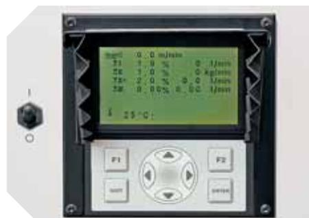
▲ Nel display sono visualizzati i parametri operativi, le quantità di legante aggiunte e la velocità di avanzamento della macchina
