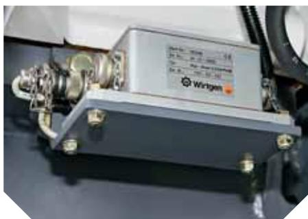
Controllo con precisione profondità e pendenza di fresatura
