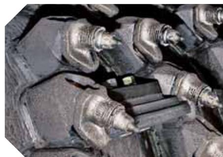
I portadenti disposti in modo elicoidale sul rullo fresante possono essere sostituiti senza difficoltà
