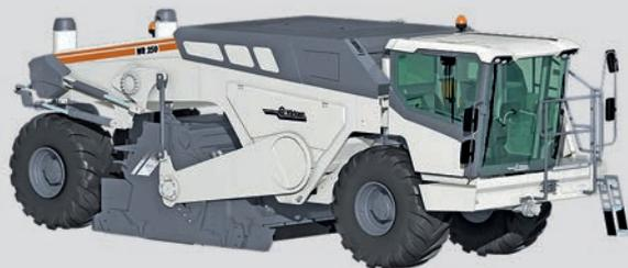
La WR 250 è una macchina ad alte prestazioni per compiti particolarmente impegnativi. Grazie all'enorme capacità di fresatura e miscelazione, la WR 250 è in grado di eseguire gli interventi più gravosi di stabilizzazione delle terre e di polverizzazione di conglomerato bituminoso duro. Con tutti i suoi pregi, la WR 250 è il punto di riferimento assoluto per affrontare le maggiori sfide nella stabilizzazione delle terre e nel riciclaggio a freddo.
