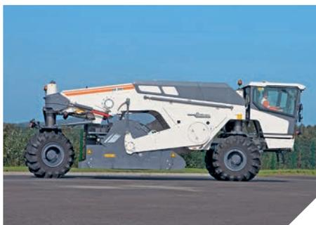
◀ Il sistema a cilindri di sollevamento con escursione fino a un max. di 500 mm consente una grande corsa oscillante e un'ampia luce libera da terra
