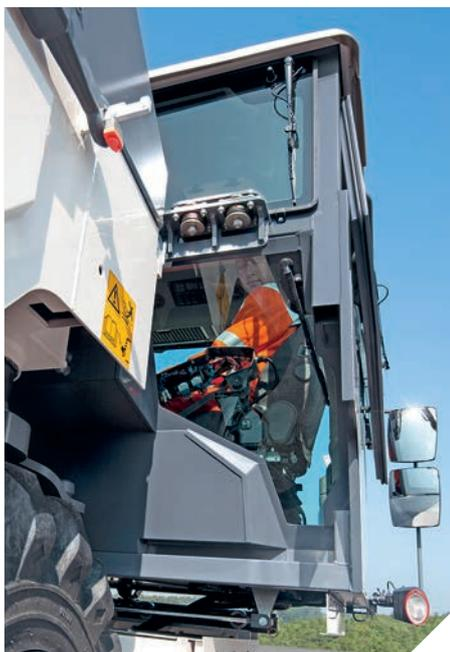
▲ Girando il sedile con la cabina traslata lateralmente, l'operatore ha un'ottima visuale sul bordo di lavoro destro
