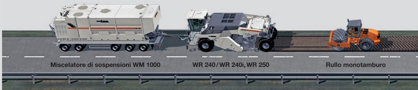
La WR polverizza con il suo potente rotore di fresatura e miscelazione gli strati in conglomerato bituminoso ammalorati con parti della sottostruttura senza aggiunta di leganti. Mentre una motolivellatrice esegue la sagomatura del fresato omogeneo così preparato, diversi rulli Hamm provvedono alla sua compattazione.
