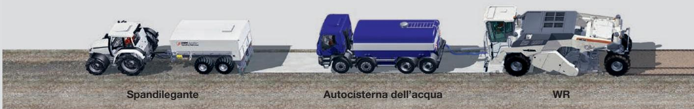
Per l'omogeneizzazione il potente rotore di fresatura e miscelazione della WR granula la terra esistente senza l'aggiunta di leganti, dissodandola. Mentre una motolivellatrice esegue la sagomatura della miscela omogenea di terra così preparata, diversi rulli Hamm provvedono alla sua compattazione.
