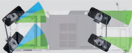
**Modalità di sterzata "curva" con sovrasterzata:** una volta raggiunto un determinato angolo di sterzata si possono sterzare ulteriormente le ruote posteriori agendo sul volante. La sovrasterzata consente raggi di sterzata ancora più contenuti.
