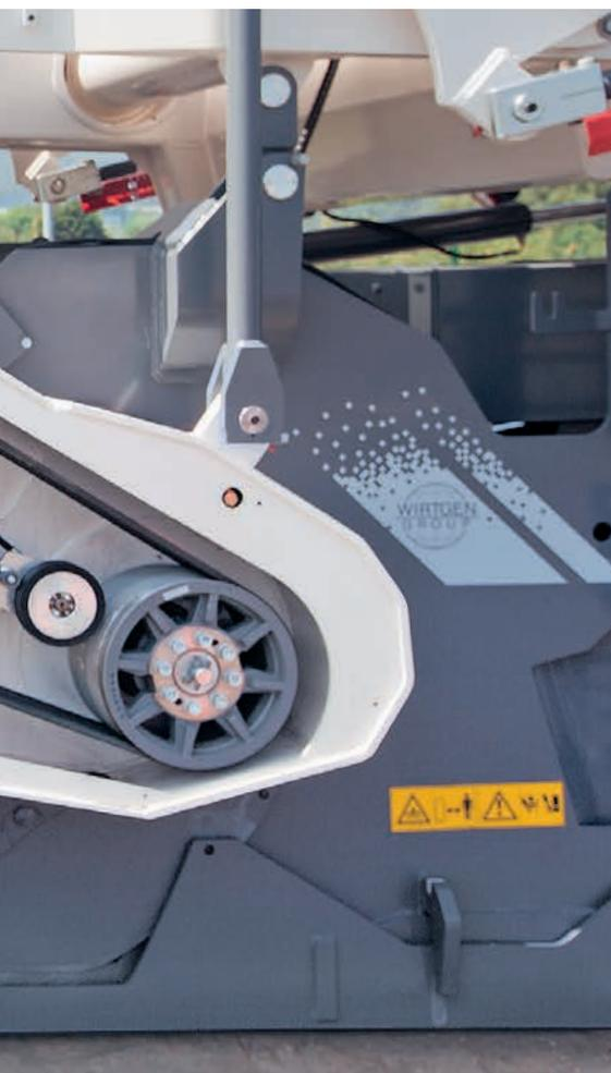
◀ L'efficiente sistema di trasmissione è facilmente accessibile e manutenibile
