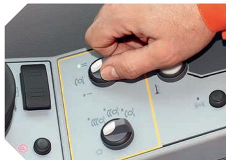
Impostando il regime di rotazione del motore, cambiando il rapporto di trasmissione del riduttore del rotore dalla cabina...
