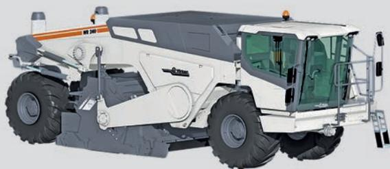
La WR 240/WR 240i è la tuttofare nella flotta Wirtgen. Grazie all'ampia larghezza e profondità operativa e alla grande capacità di fresatura e miscelazione, la WR 240/WR 240i offre la massima flessibilità per tutti gli interventi di stabilizzazione delle terre e di riciclaggio a freddo.
