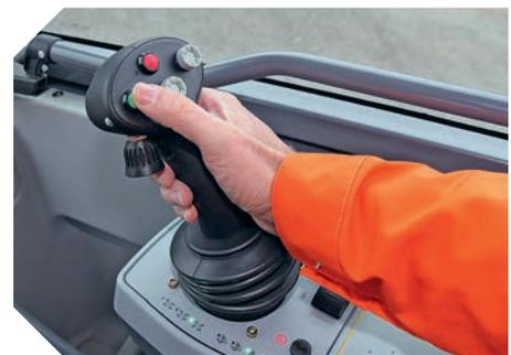
Le telecamere possono essere commutate manualmente con il joystick
