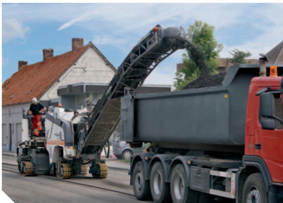
▲ Il premizolle abbassato idraulicamente permette di ottenere un fresato di piccola granulometria senza il distacco di zolle
