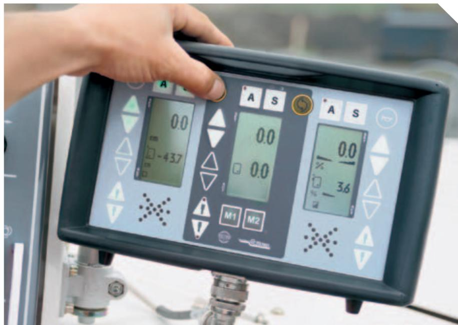
Il nostro precisissimo sistema di livellazione LEVEL PRO, sviluppato specificamente per le scarificatrici a freddo, si compone del display LEVEL PRO, dell'unità di controllo e di vari sensori.
