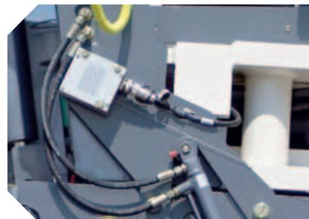
Il sensore a cavo flessibile per profondità di fresatura precise
