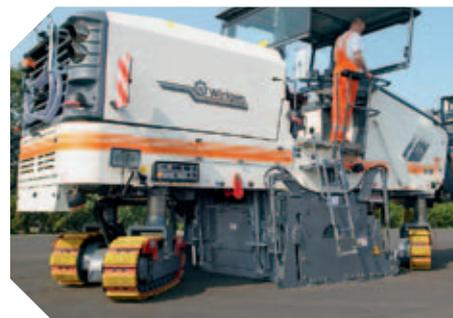
▲ Gli ampi angoli di sterzata di tutti i cingoli rendono possibili raggi di curvatura contenuti
