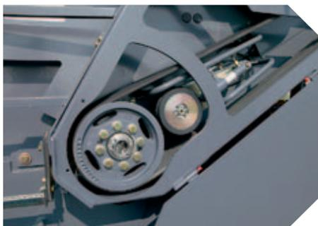
▲ Il dispositivo di rotazione per il posizionamento preciso del rullo fresante
