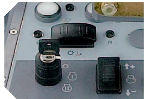
È possibile avviare il motore 2 manualmente per mezzo del bloccetto d'accensione a chiave ▲
