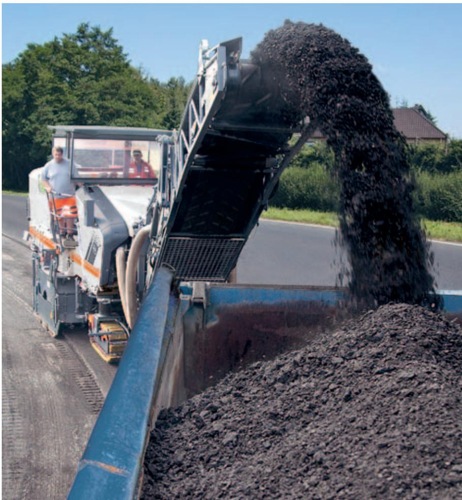
◀ Il nastro di carico della W 210 / W 210i è dimensionato per la massima portata
