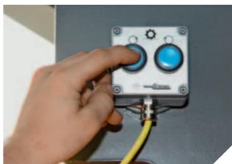
▲ La pulsantiera di comando remoto completa di un lungo cavo spiralato per ruotare il rullo fresante
