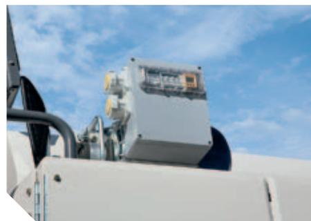
Il gruppo elettrogeno ad azionamento oleodinamico al quale si possono collegare fino a due palloni illuminanti
