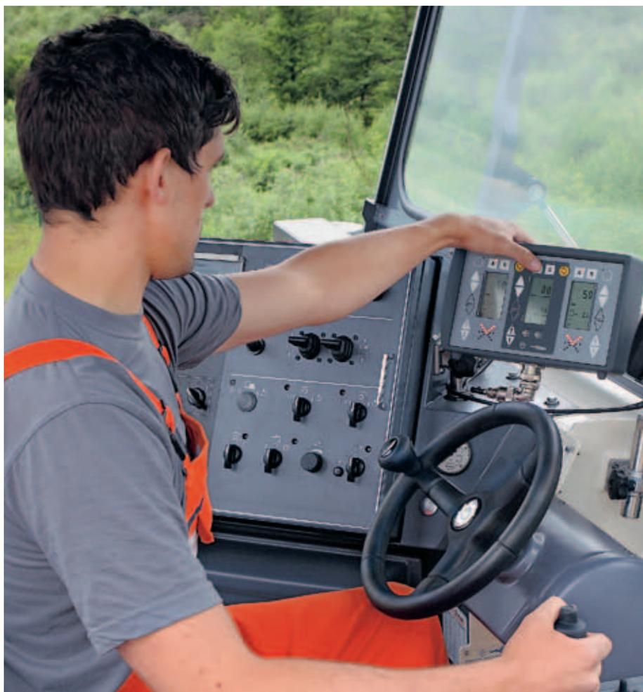
◀ Con il LEVEL PRO è facile per l'operatore impostare la profondità e la pendenza di fresatura
