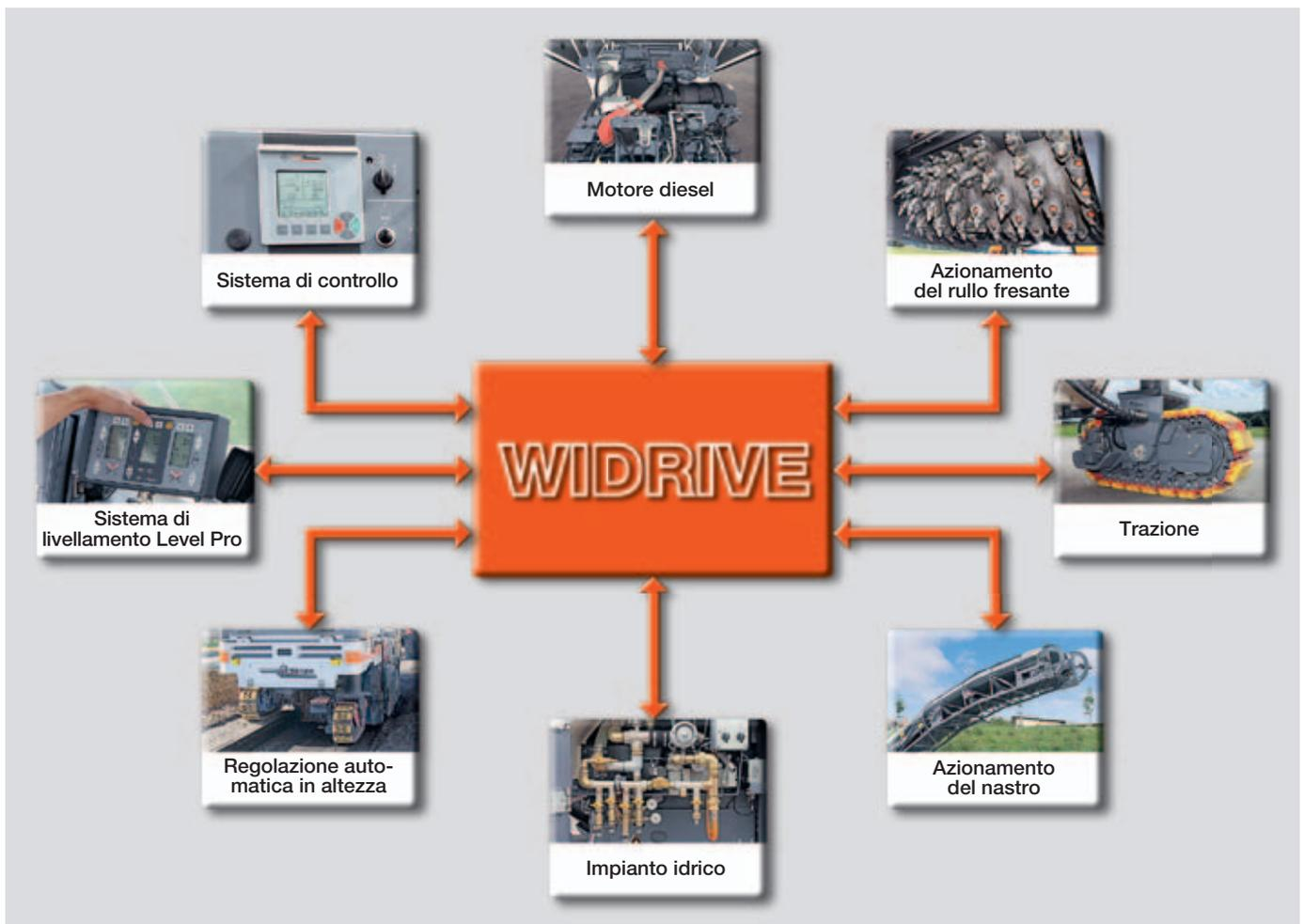
WIDRIVE, il sistema di controllo intelligente della macchina, garantisce la massima potenza e resa superficiale poiché si assume molte delle operazioni e funzioni cui è normalmente preposto l'operatore. A seconda dell'intervento da eseguire, WIDRIVE controlla ad esempio in automatico il regime di rotazione del motore diesel, inserisce o disinserisce l'impianto irrigatore, monitora e regola
