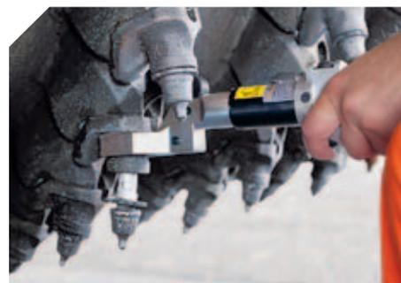
Una volta aperta la lama raschiatrice il rullo fresante è ben accessibile per la sostituzione dei denti.
