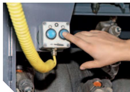
Il pulsante del dispositivo idraulico di rotazione del rullo fresante viene fissato magneticamente a portata di mano dell'operatore ▲
