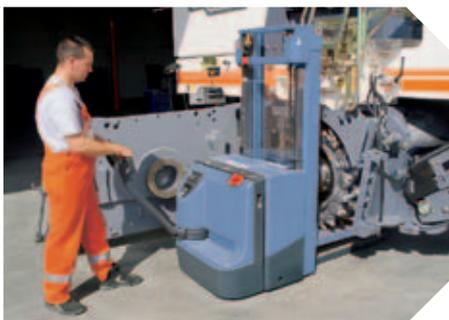
▲ Le operazioni di cambio del rullo fresante sono agevolate dalla paratia laterale ad ampio angolo di apertura
