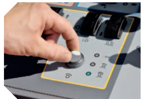
Regime di rotazione medio: scarifica di manti d'usura, pavi- mentazioni stradali sottili ecc.
