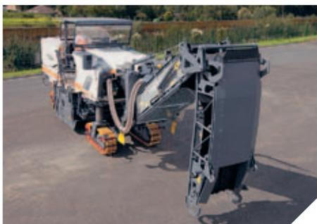
◀ Il nastro di scarico ripiegabile idraulicamente accorcia la lunghezza di trasporto della W 220
