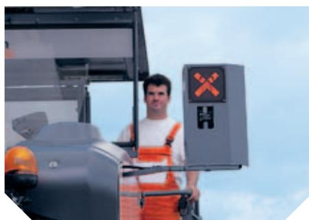
◀ L'impianto semaforico dà al camionista silenziose istruzioni di "stop and go", rivelandosi assai utile specie negli interventi notturni
