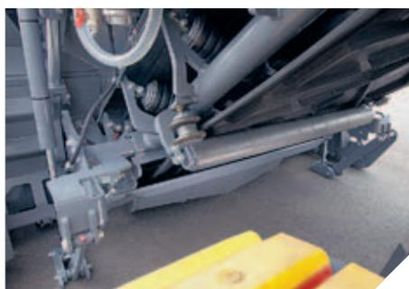
◀ Scansione dell'altezza davanti al rullo fresante per mezzo di sensori idraulici della profondità di fresatura
