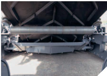
◀ Il premizolle è regolabile idraulicamente in altezza...
