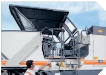
▲ Per ripiegare comodamente il tettuccio di protezione in assetto di trasporto basta premere un pulsante
