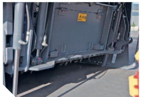
Per caricare solo una parte del fresato basta bloccare la lama raschiatrice all'altezza richiesta ▲
