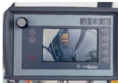
► A seconda delle richieste del cliente si possono installare due o sei telecamere a colori ad alta risoluzione.
