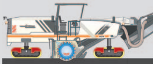
3. La W 250 si abbassa lentamente rimanendo allineata al fondo stradale
