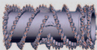
Rullo fresante standard con larghezza operativa di 2,20 m
