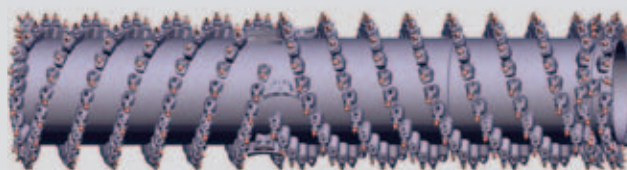
Rullo fresante standard con larghezza operativa di 4,40 m
