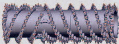
Rullo fresante standard con larghezza operativa di 3,10 m
