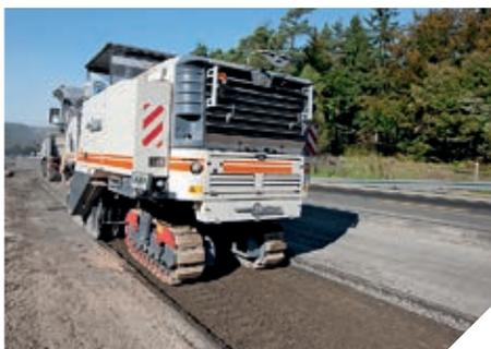
◀ Scarifica di uno strato d'usura e di binder spesso 11 cm in conglomerato bituminoso duro con l'ECO-cutter da 2,2 m
