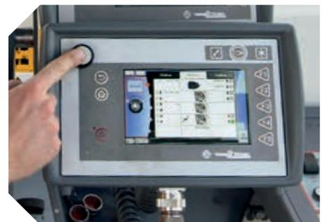
▲ Comoda apertura idraulica del cofano motore con la semplice pressione di un pulsante
