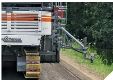
◀ Sistema multiplex: due sensori a ultrasuoni e i sensori sulle paratie laterali rilevano la profondità di fresatura
