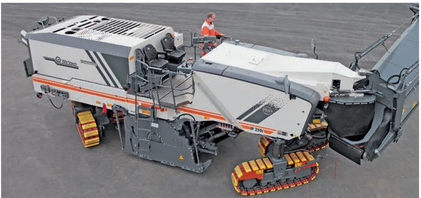
/// Quando a una grande scarificatrice sono richieste buone doti di maneggevolezza o di avanzamento su fondo difficile, scocca l'ora della W 250i. Tutto ciò non è solo merito della sterzata idrostatica integrale, dei modi di sterzata liberamente selezionabili, dei cingoli regolabili idraulicamente in altezza e della velocità di marcia regolabile in continuo. Vi contribuisce pure l'intelligente sistema
