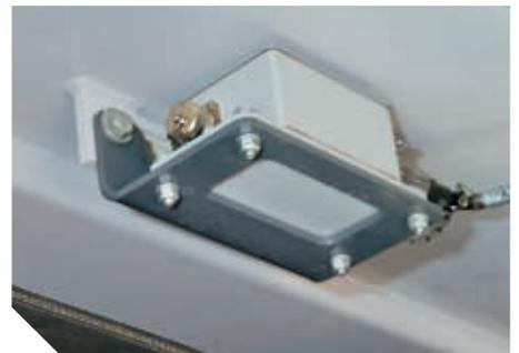
Il sensore elettronico della pendenza trasversale "Rapid Slope" permette di fresare con una determinata pendenza trasversale ▲
