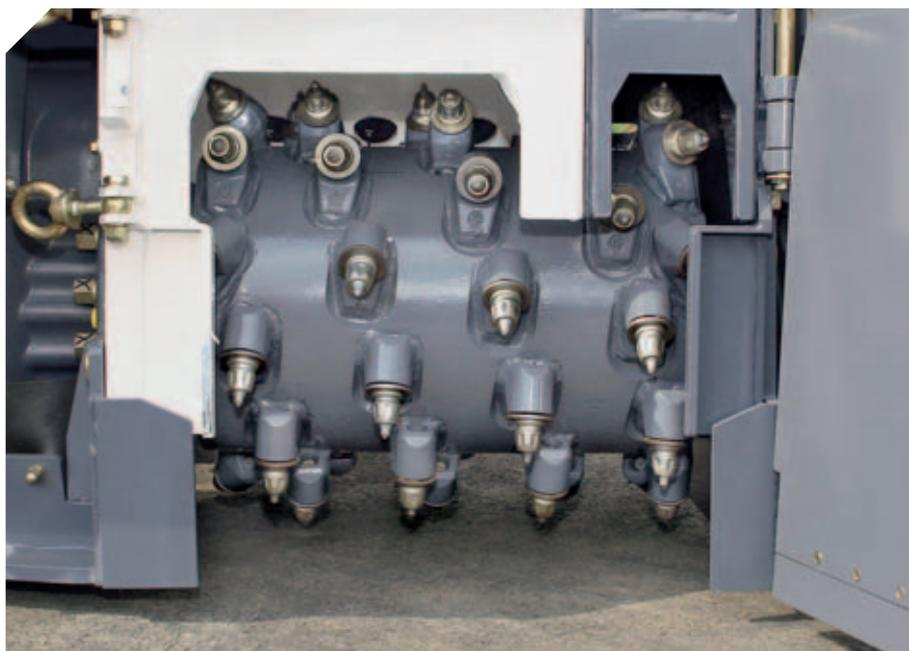
▣ Grazie all'architettura ben congegnata della macchina si possono impiegare in modo flessibile diversi rulli per le più svariate applicazioni di fresatura.
