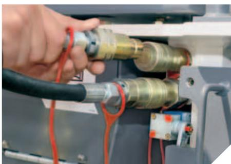
◀ Il nastro di carico viene agganciato alla macchina per mezzo di innesti idraulici rapidi
