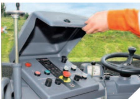
◀ Un coperchio munito di serratura a chiave protegge il quadro di comando da atti vandalici
