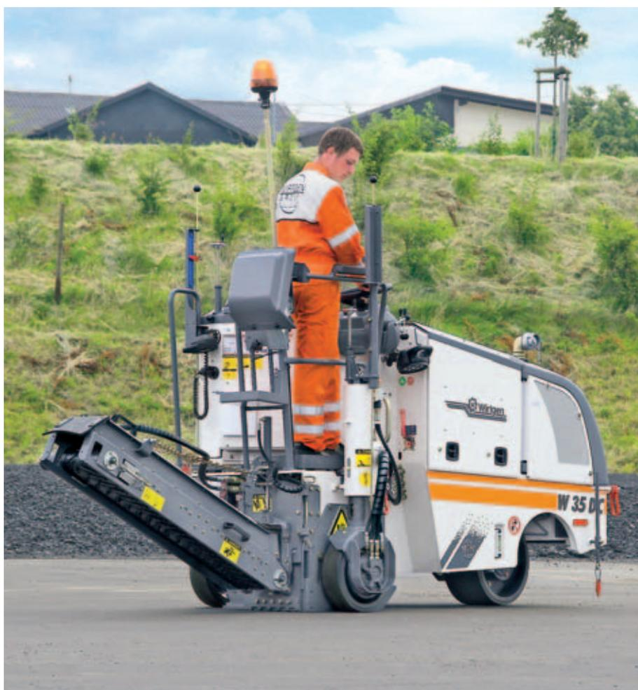
◀ Con il nastro di carico posteriore (retrofittabile) la W 35 DC si trasforma in una fresa multifunzionale
