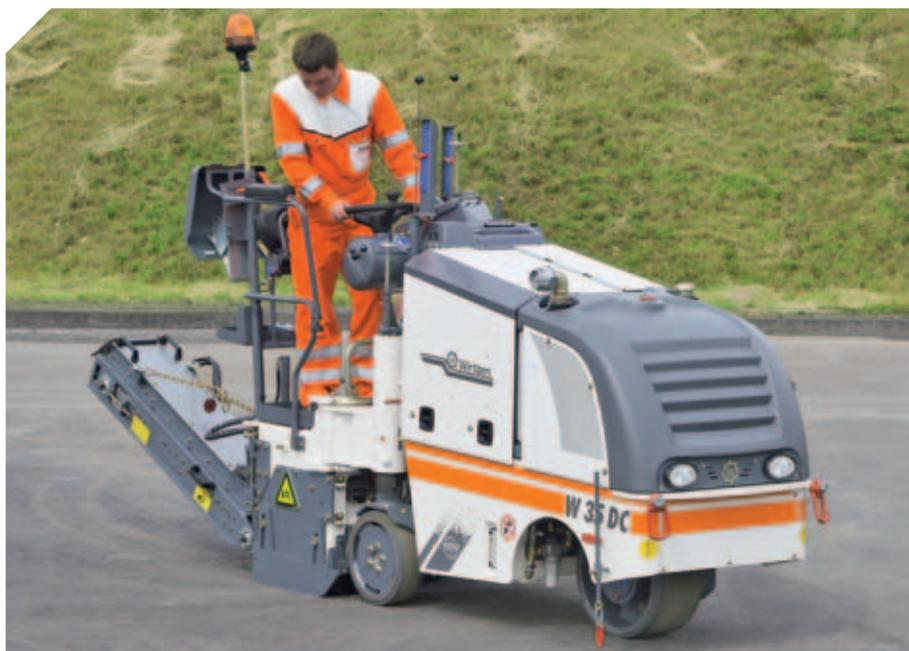
▣ Anche con la ruota posteriore rientrata il macchinista può vedere perfettamente il bordo di fresatura.
