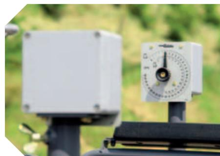
▲ A richiesta la profondità di fresatura può essere indicata da strumenti a quadrante con trasmissione a cavo flessibile
