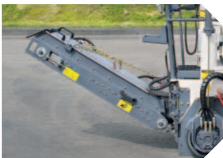
▲ L'altezza di scarico è variabile per convogliare il fresato in modo affidabile nella benna di una pala gommata o nel cassone di un mini dumper
