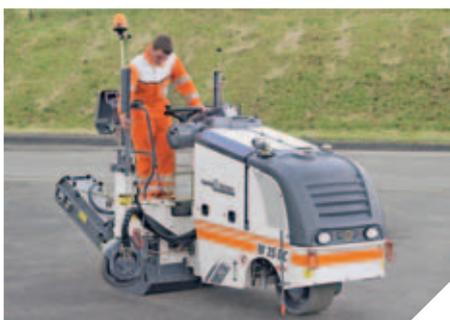
◀ La ruota posteriore destra rientrabile amplia il ventaglio applicativo della macchina
