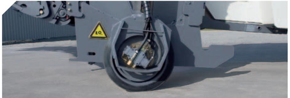
▣ Le due velocità di regolazione (veloce o lenta) dell'altezza da terra della macchina per mezzo delle ruote posteriori consentono di superare agevolmente eventuali ostacoli per spostare rapidamente la macchina in cantiere.
