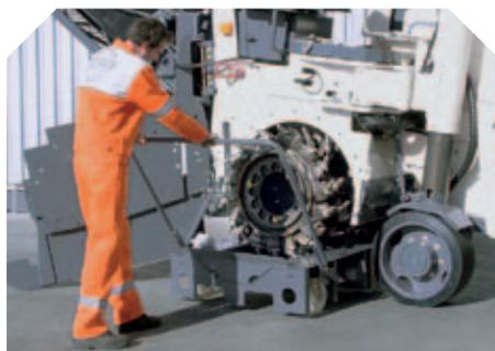
Si sostituisce soltanto il tubo del rullo attrezzato con i portadenti ▲
