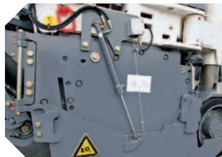
Sensore a cavo flessibile per l'accurata misurazione della profondità di fresatura
