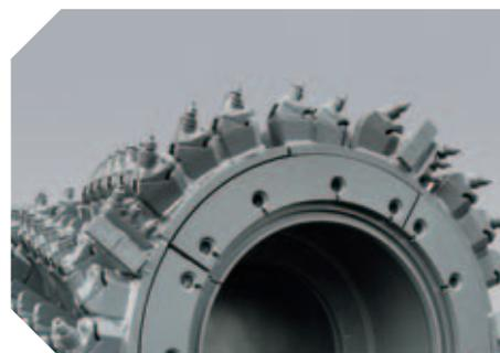
Segmenti angolari sostituibili singolarmente: il rullo è capace di avanzare anche lungo raggi stretti ▲
