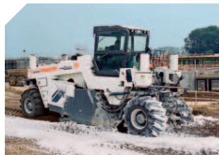
➤ Rispetto alle macchine con un solo asse motore, che spesso rimangono impantanate nei terreni difficili, la WR 2500 S riesce ad avanzare ovunque a velocità costante.
