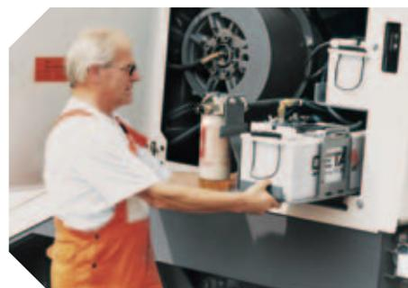
▲ I filtri aria, il bocchettone per il rabbocco dell'olio motore e l'astina dell'olio sono ben accessibili
