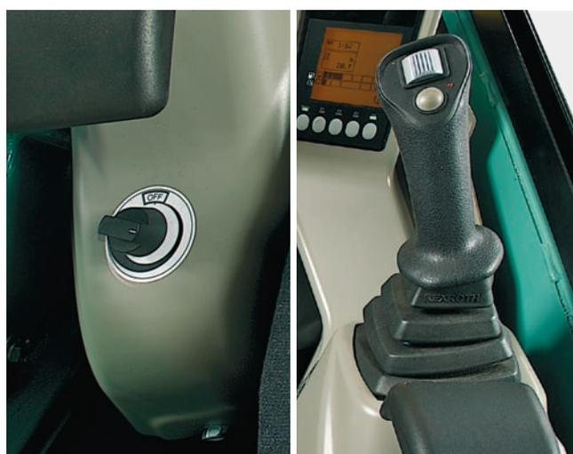
Per aumentare ulteriormente la polivalenza operativa è acquistabile in opzione una seconda linea idraulica supplementare a comando proporzionale dotata di potenziometro per la regolazione della portata massima.
