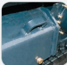
Sottocarro e lama dotati di punti di fissaggio
