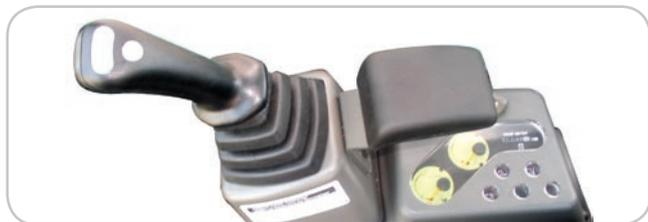
Comando del circuito idraulico ausiliario con pulsante pedale
