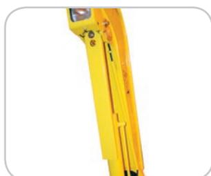
> I steli dei cilindri del braccio e del bilanciante sono protetti.
