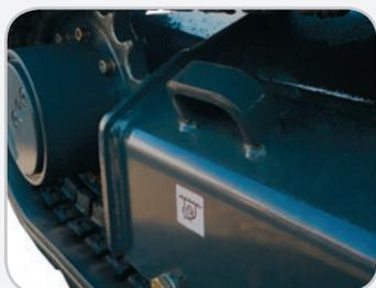
Sottocarro e lama dotati di punti di fissaggio per la messa in sicurezza della macchina in fase di trasporto su un rimorchio
