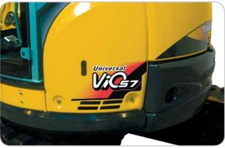
> La protezione laterale del telaio è composta di una lastra d'acciaio più spessa nella quale sono aggiunti fazzoletti metallici per aumentare la sua resistenza contro gli urti ed evitare i danni contro i muri.
