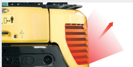
Uscita dell'aria di raffreddamento del motore orientata verso l'alto (protezione delle persone e piante circostanti)
